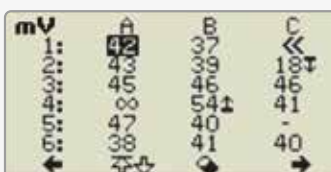
La función de lote de red facilita un análisis rápido de las lecturas de media celda
